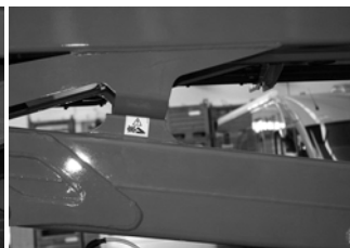
Fig. 117 Gefahr der Scherung auf Maschine 3
