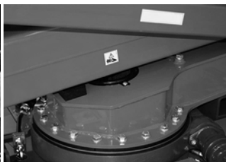
Fig. 116 Gefahr der Scherung auf Maschine 2
