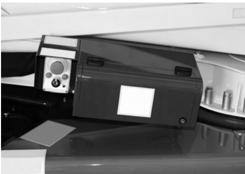
Fig. 67 Verkleidung Hydrauliksteuerungen am Boden
